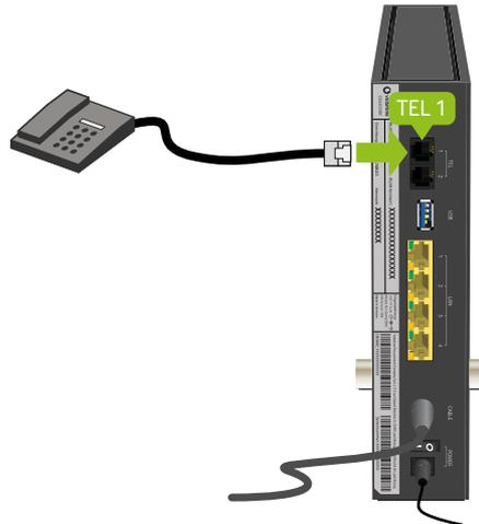
Schließen Sie das kabelgebundene Telefon, die DECT-Basisstation oder das Faxgerät an einen der **TEL**-Anschlüsse am CGA4233DE an.
